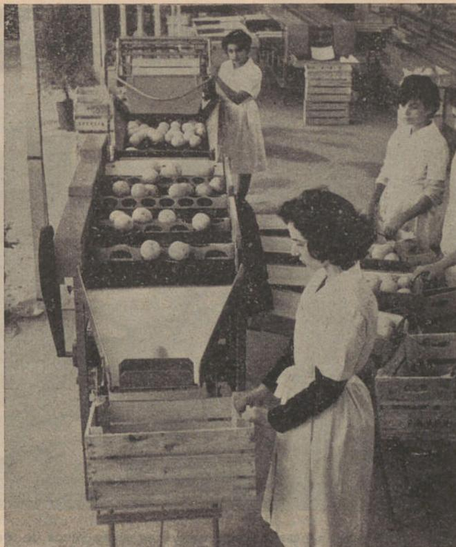
Foto 3 — Equipamento destinado a uma empresa de menor movimento. Rendimento horário: 1000 kg de fruta escolhida e calibrada
