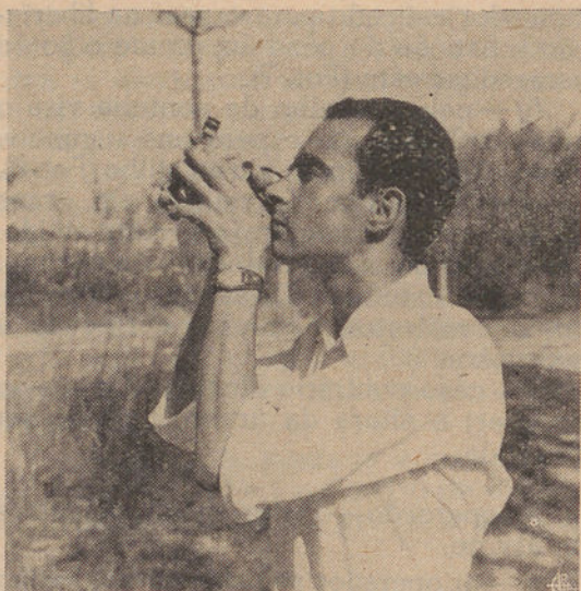
Fot. 7 — Posição correcta do aparelho quando se faz a visada para o cimo da copa e para a base do tronco. A mão direita segura o hipsómetro como um revólver e a mão esquerda ajuda a ganhar firmeza nas pontarias
