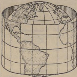
Fig. 34 — Esfera terrestre envolvida por um cilindro, afim de se obter o planisfério
