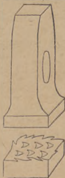
Fig. 73 — Calçar de aço com calda a topo.
