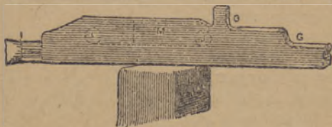
Fig. 129 — Forjar o caixilho para leme (II)
