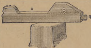
Fig. 130 — Forjar o caixilho para leme (III)
