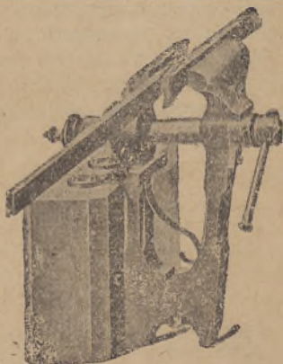
Fig. 74 — Caldear por compressão nas bocas de um torno
