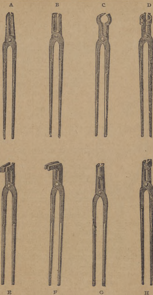
Fig. 20 — A , tenaz direita — B , tenaz de canal — C , tenaz de garganta — D , tenaz de boca-de-lobo — E , tenaz de boca-de-sapo — F , tenaz torta — G e H , tenazes de caixa.
