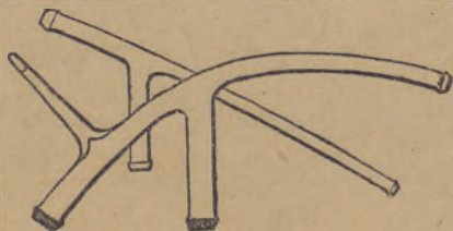
Fig. 132 — Forjar o caixilho para leme (IV)
