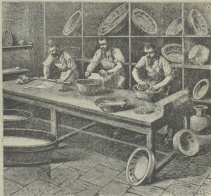
Fig. 89 — Applicaçào das folhas d'argilla nos moldes de gesso
