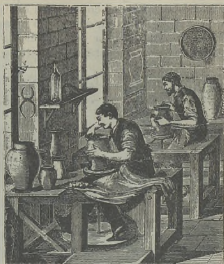
Fig. 69 — Roda do oleiro
