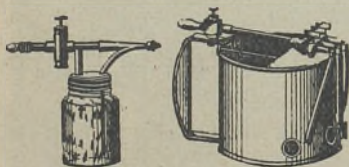
Fig. 113 e 114—Pulverizadores ou injectores Wenger, para vidrados simples e a côres
