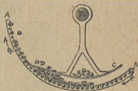
Fig. 131 —Separador de sementes redondas
