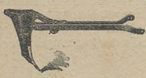
Fig. 106 — Dente articulado, posição normal
