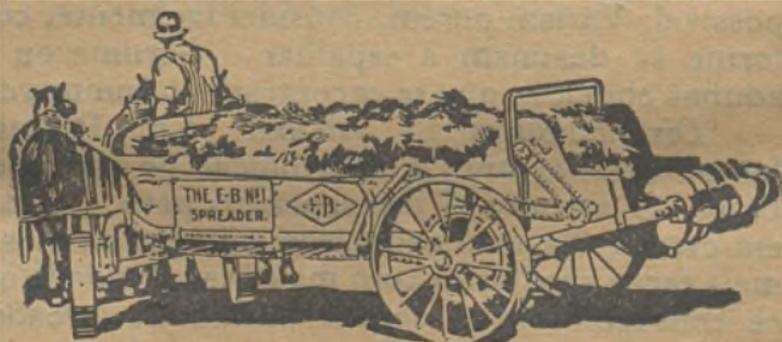
FIG. 22—Carro distribuidor de estrume
