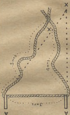
Fig. 36 — Modo de levantar uma perpendicular com a corda; a cavilha A da direita, deve espetar-se no ponto onde se pretende levantar essa perpendicular.
