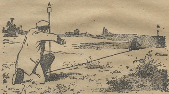
Fig. 30 — Modo de medir a distância entre os pontos A e B
