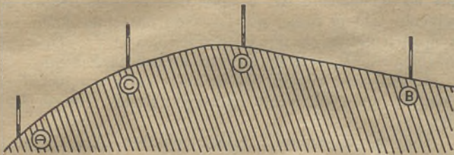
Fig. 27 — Modo de marcar um alinhamento entre os pontos A e B, que se não vêem um do outro.
