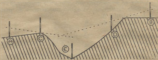
Fig. 26 — Modo de traçar um alinhamento em terreno onde há um fôso ou cova
