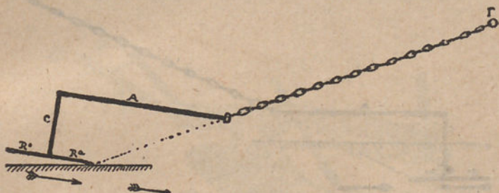
Fig. 7 — Linhas gerais da charrua. Posição que toma a charrua ao ser acionada; o bico da relha tende a ferrar-se na terra.
