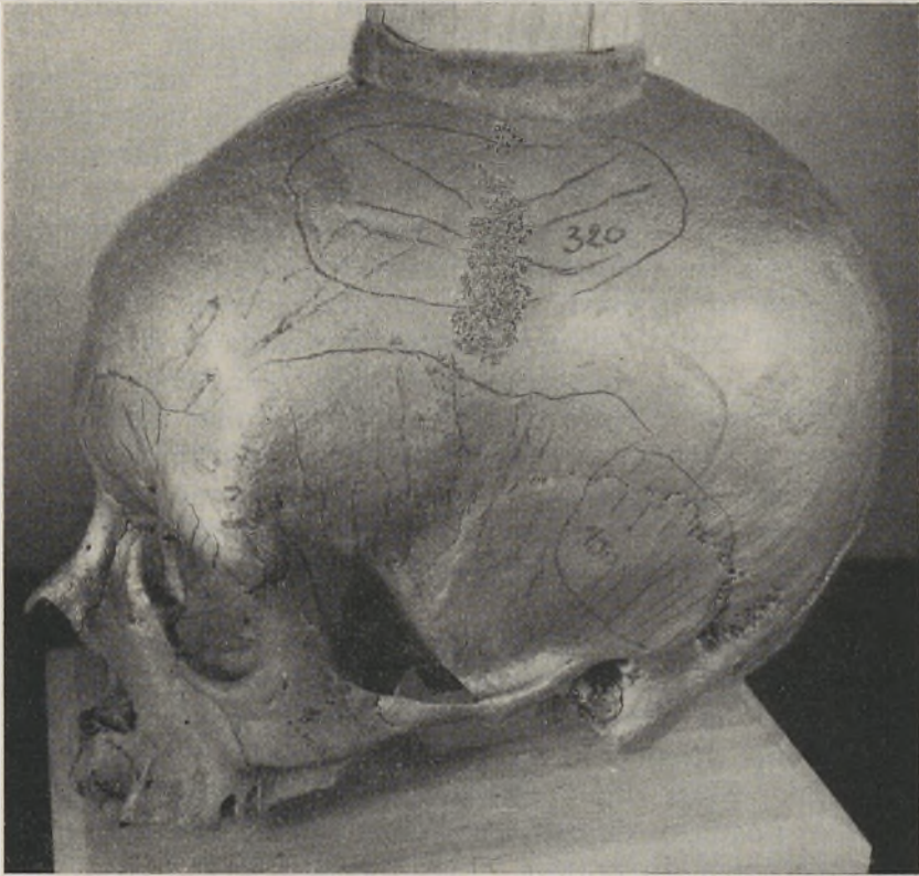
FIG. 3 — Linhas de transmissão de esforços num crânio de adulto. (Técnica dos vernizes frágeis)
