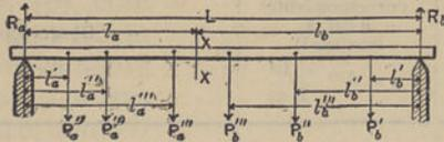
Fig. 17—Momento de flexão na secção XX de trave simples
