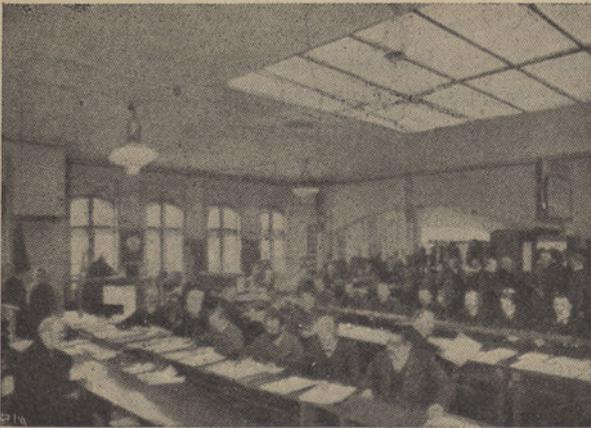
Fig. 10—Iluminação dum escritório com lâmpadas de arco
