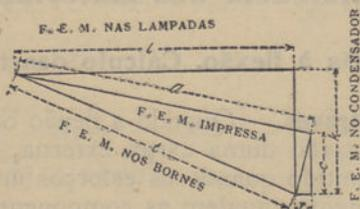
Fig. 20—Diagrama das forças electro-motrices da fig. 18 excepto que a carga de indutância é substituída por uma carga de condensador
