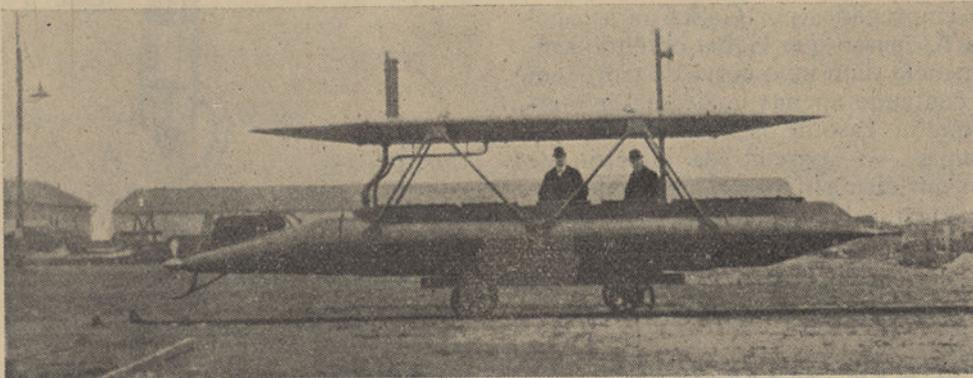
Fig. 1—O torpedo que pode ser guiado pela telegrafia sem fios
