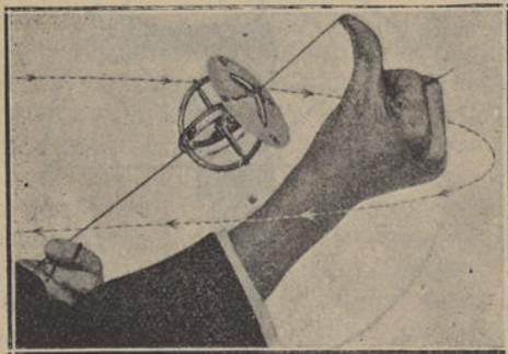
Fig. 3— Se o peão giroscópico fôr assim seguro e a pessoa que o sustenta revolver sobre os seus calcanhares da esquerda para a direita, o «norte» aponta para baixo
