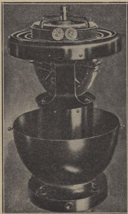
Fig. 1 -- A giro-bússola, mostrando a bitácula com a cobertura retirada e a caixa abaixada
