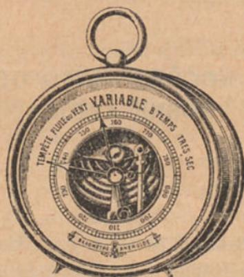
Fig. 22—Um barómetro metálico.
