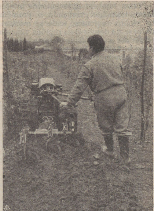
Os motocultivadores mostraram as largas possibilidades da sua aplicação na cultura da vinha. Um motocultivador de 12 Hp com char-rua trifólia efectuando uma cava
