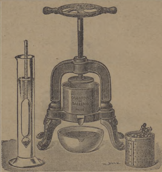
FIG. 4 — Mustimetro Dujardin e prensa do mesmo auctor, para esmagar cachos destinados a ensaios de m o sto
