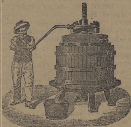
Fig. 13 — Prensa de bagaço, typo Mabille
