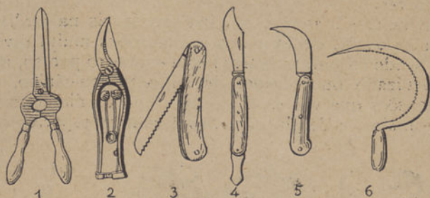
Fig. 55 — Material para poda e enxertia: 1, tesoura de tosquiar; 2, tesoura de poda; 3, serrote; 4 e 5, navalhas de enxertia; 6, foice
