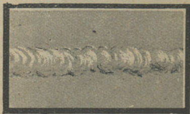
Fig. 171. - A mesma soldadura executada com chama oxidante.
