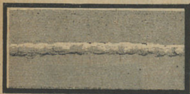
Fig. 149. — Soldadura de chapa de alumínio de 8/10 de m/m (tamanho natural).
