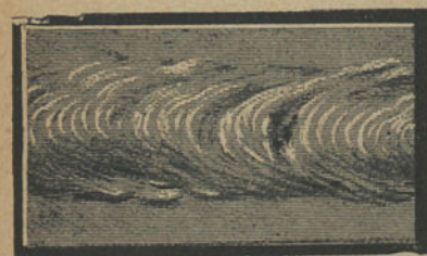
Fig. 151. — Soldadura de chapa de alumínio de 5 m/m.
