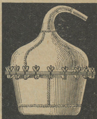
Fig. 168. — Alambique de cobre inteiramente construído pela soldadura autogenea.
