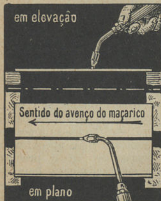
Fig. 59. — Sentido de avanço e posição de maçarico.
