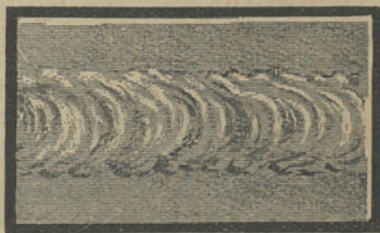
Fig. 166. — Soldadura de chapa de cobre de 4 m/m (tamanho natural).
