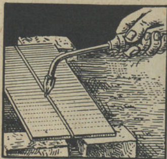
Fig. 58. — Posição do soldador em relação á linha de soldadura a executar.
