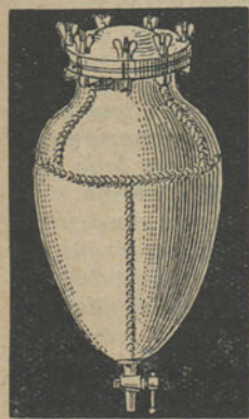
Fig. 161. — Peça de caldeiraria de cobre construída pela soldadura autogenea.
