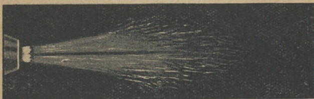
Fig. 183. — Regulação final com oxigénio de corte aberto.
