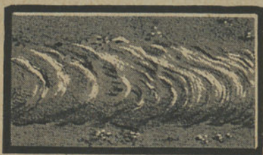
Fig. 99. - Soldadura de chapa 5 m/m executada por um principiante (tamanho natural).
