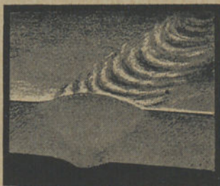
Fig. 114. - Corte de uma soldadura atacada também pelo lado oposto.
