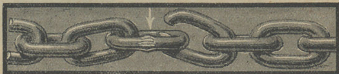
Fig. 123. — Corrente com elos soldados, ensaiada á tracção; as rupturas dão-se fora das zonas soldadas (espessura do metal 15 m/m).
