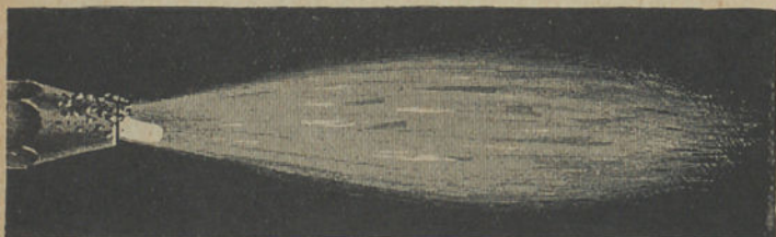
Fig. 34. — Bico entupido com partículas de óxido.
