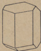
Fig. 65. Crystal de hornblenda com a fórma composta \infty P . \infty P \infty . 0P . P .
